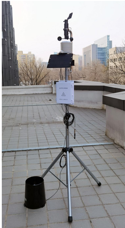
北大荒集团使用太阳能全自动气象站
