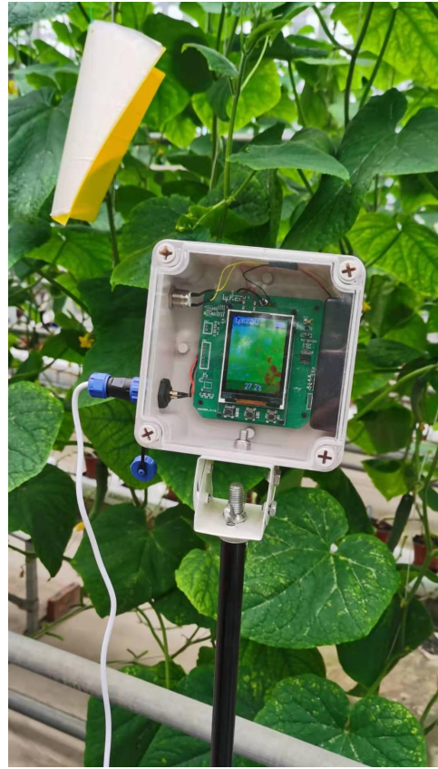
农机研究所叶片温度红外监测
